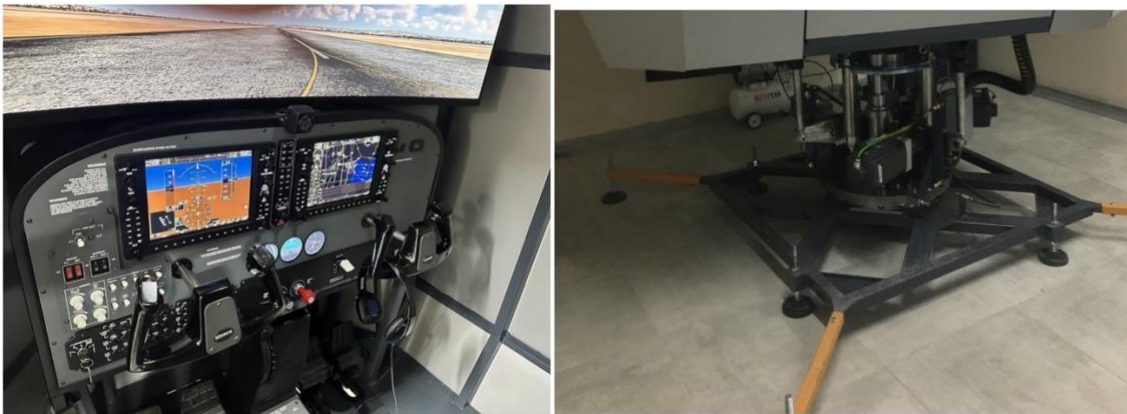
Şekil 5: Cessna 172P uçağı kokpit tasarımı ve pnömotik sistem bazlı çalışan dört adet elektrik motoru
